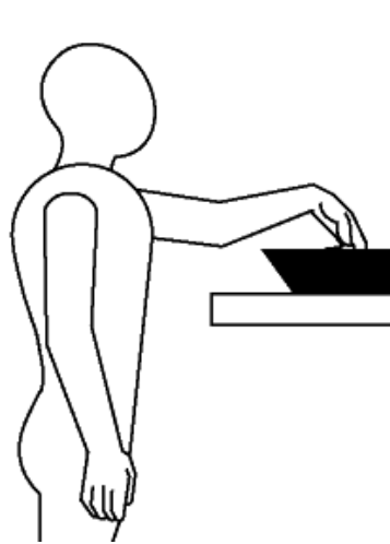
Gambar 3A – Gerakan menjangkau yang berbahaya – menjangkau ke depan
